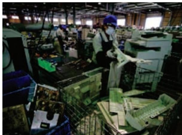
株式会社リサイクルテックでは、使用済みのOA機器（コピー機、ファクシミリ、パソコンなど）を分解し、高度に選別することにより、再生原料を生産している。
