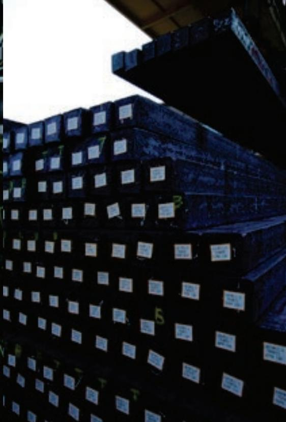
鉄くずを主原料として製造されたピレット((株)宇部スチール)
